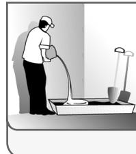
**Mezcla Manual:** En una superficie limpia y plana vierta Adilisto Pega Enchape dejando una cavidad en el centro para verter parte del agua de amasado. Revuelva minuciosamente con pala. Agregue el agua faltante y termine de revolver hasta que la mezcla esté homogénea y trabajable.
